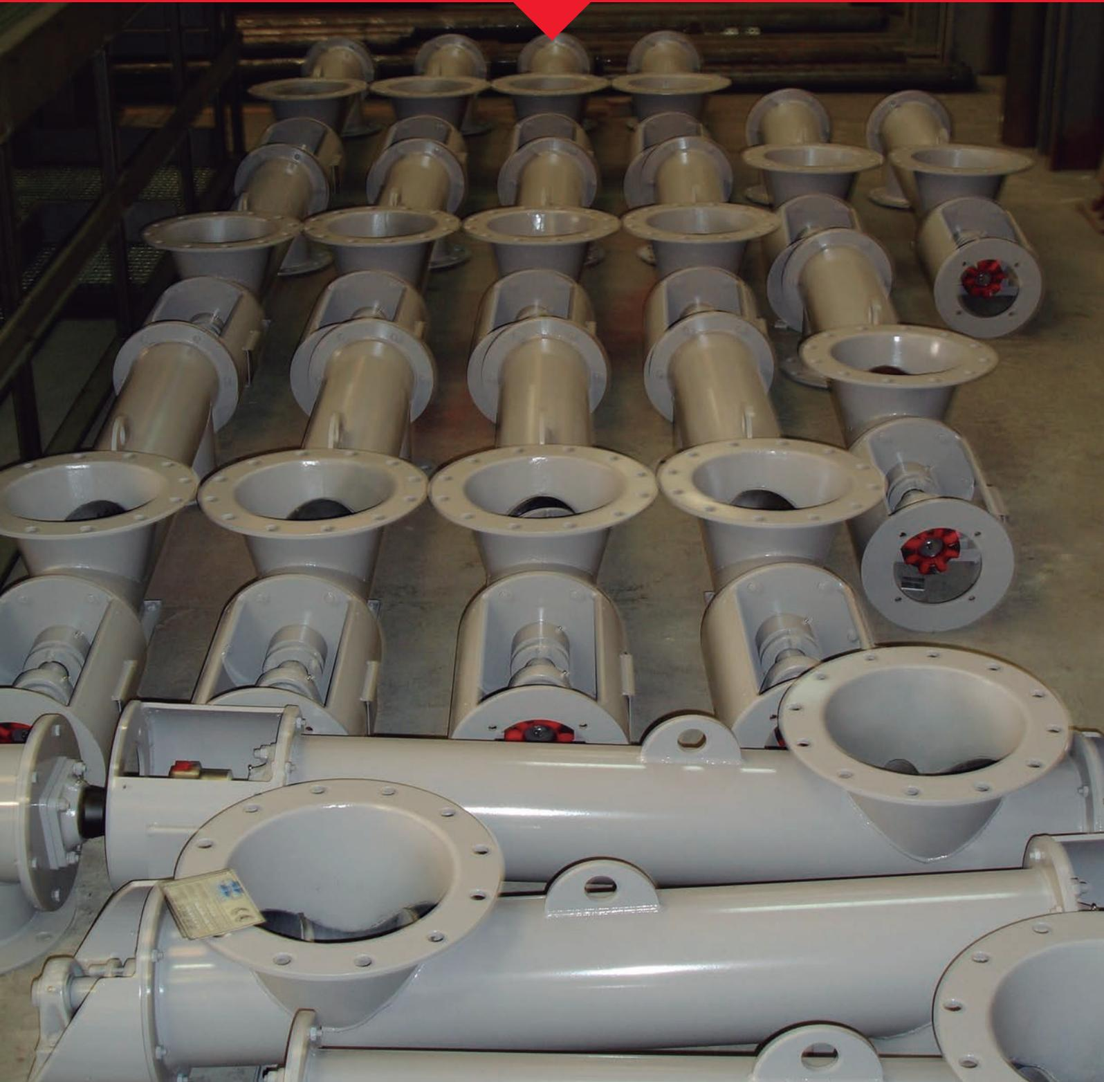
Tipo "Industrial" para el transporte de: cementos, abrasivos, arenas, yesos, ...
