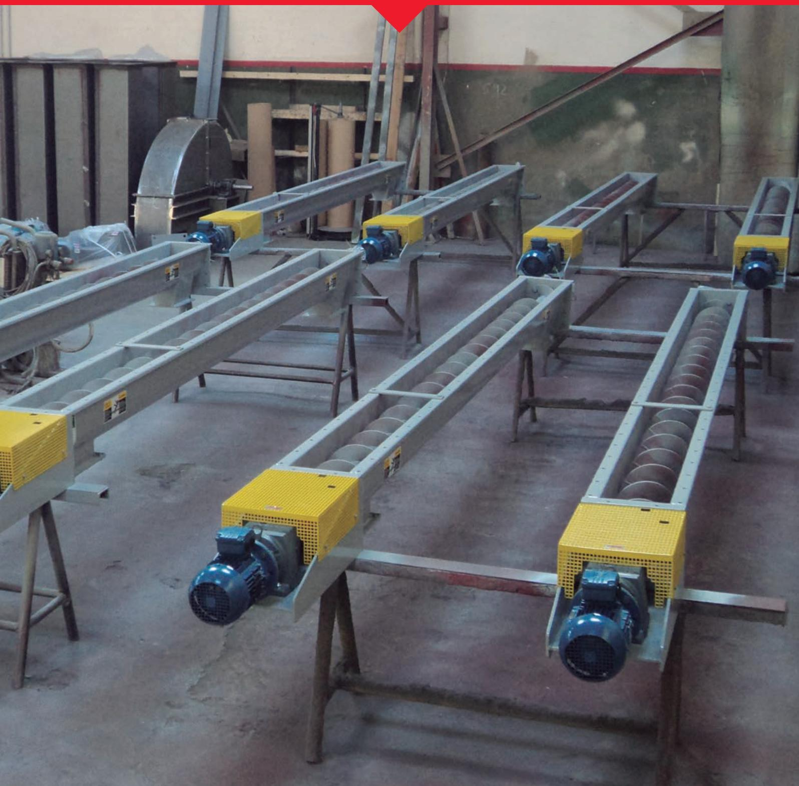
**Transportadores de canal modelo "industrial" para transportar áridos, cemento, morteros, carbón, polvos muy abrasivos, ...**
