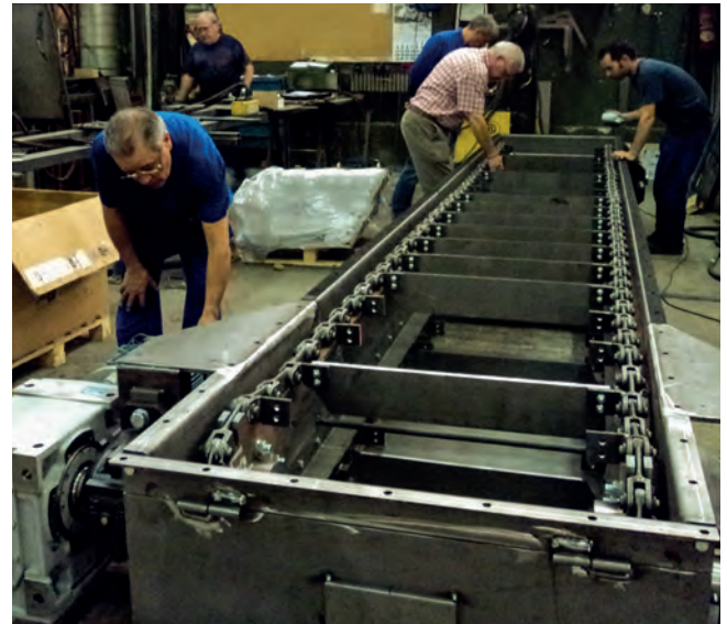
PRUEBAS DE FUNCIONAMIENTO DE REDLER
