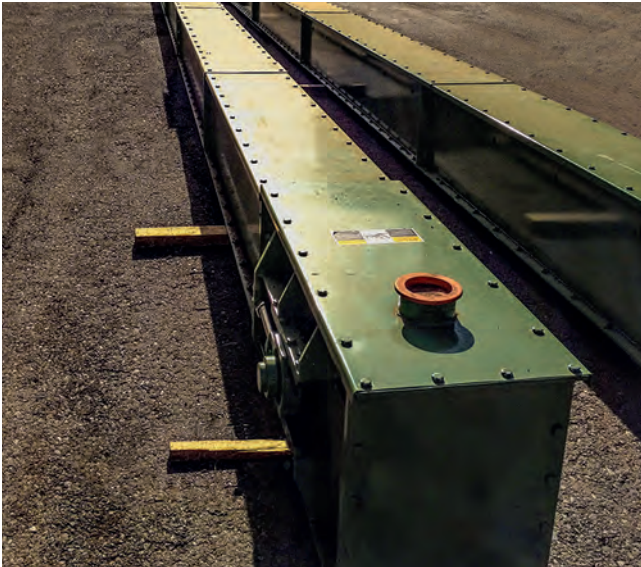
TRANSPORTADOR DE CADENA DE 60m
