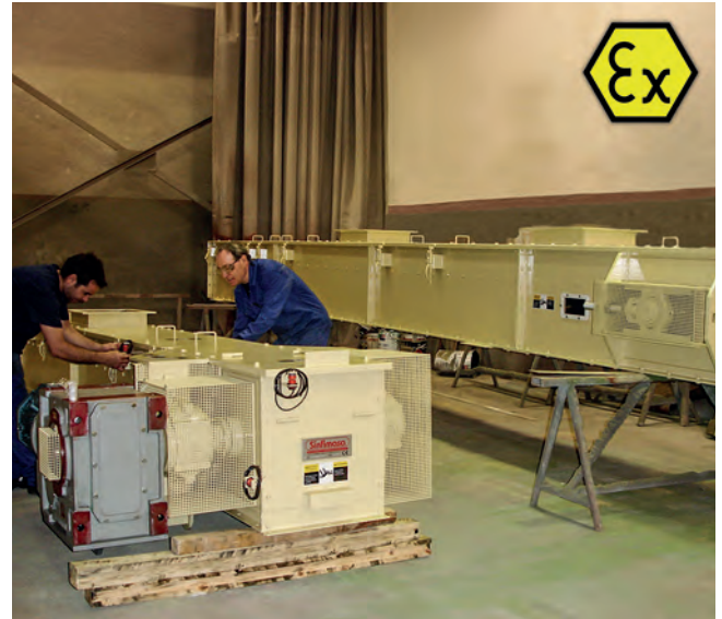
TRANSPORTADOR DE CADENA "ATEX"
