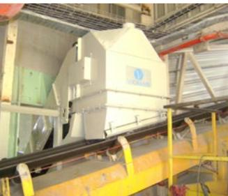
Básculas dosificadoras e integradoras especializadas para las condiciones y los materiales usados en la casa de mezclas.
