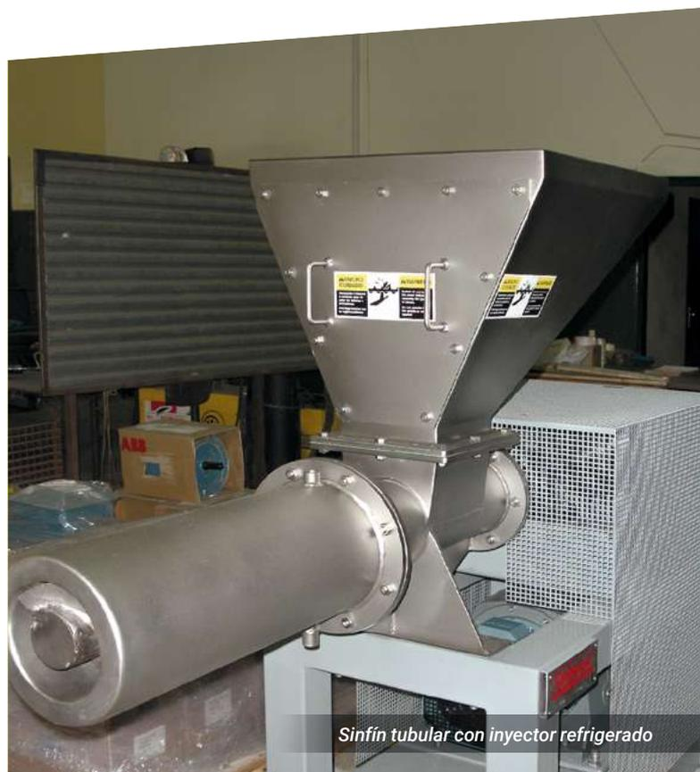
Sinfín tubular con inyector refrigerado
