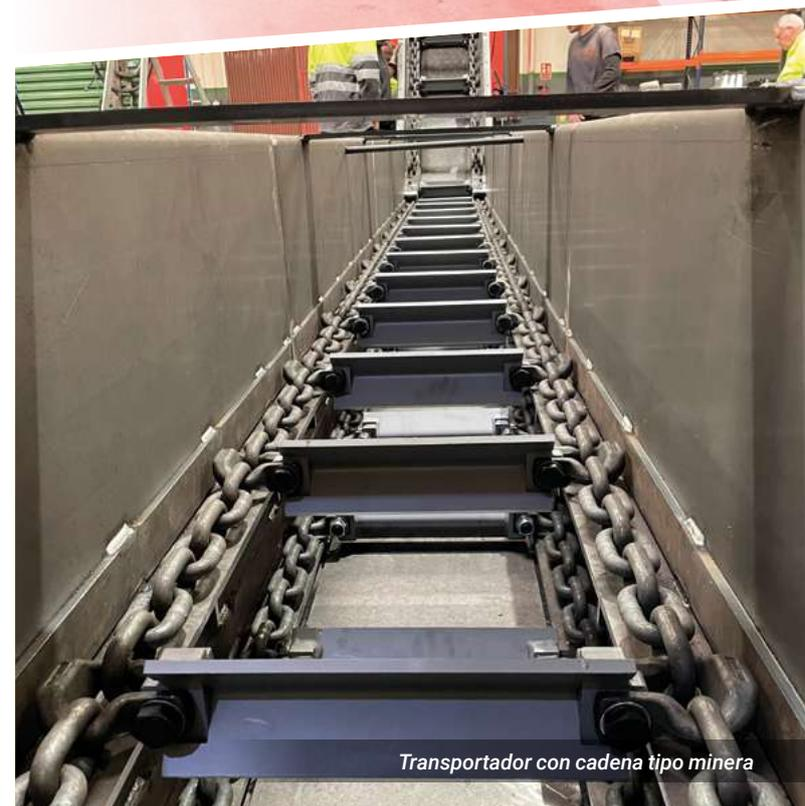
Transportador con cadena tipo minera
