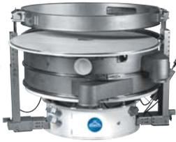
**Sono-Energy™** Separación de polvos de baja densidad. Crea una vibración ultrasónica secundaria que evita la obstrucción en mallas finas (60-635 mesh). Indicado para polvos epoxídicos, polvo de toner y pinturas en polvo. Asimismo para metales pulverulentos de alta densidad, incl. plomo, níquel y cromo.
