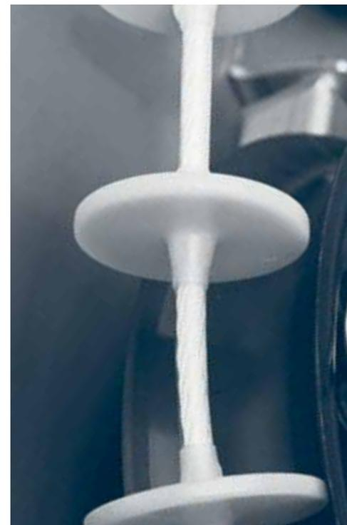
**El sistema de transporte por cable o aerotransportador** se utiliza para el transporte de graneles sólidos de bajo volumen. Solución económica que ofrece un alto grado de versatilidad.
