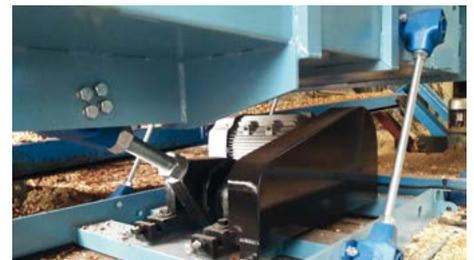
El sistema elástico del equipo puede estar formado bien por resortes de acero, articulaciones elásticas o ballestas de fibra de vidrio, dependiendo esto de la aplicación para la que se diseñe el equipo.
