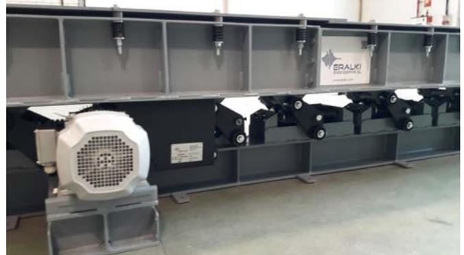
El principio de funcionamiento de estos equipos consiste en conseguir una frecuencia de trabajo común entre el sistema elástico y el accionamiento del equipo.
