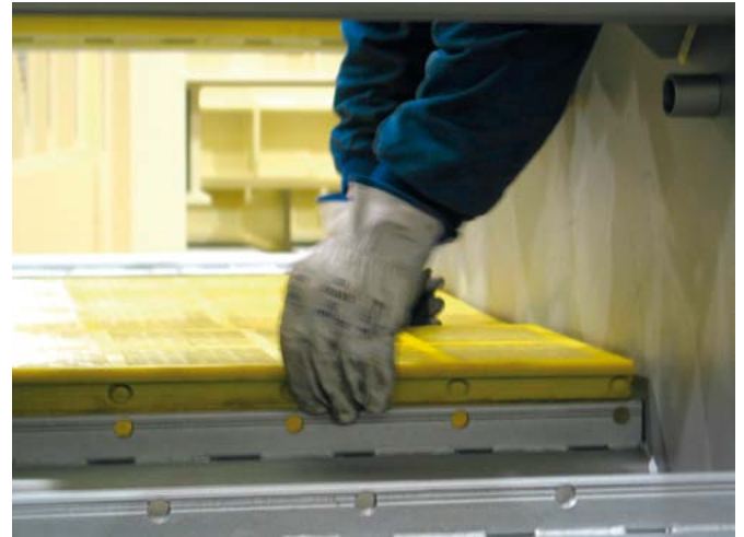
Fijación panel mediante tetones
