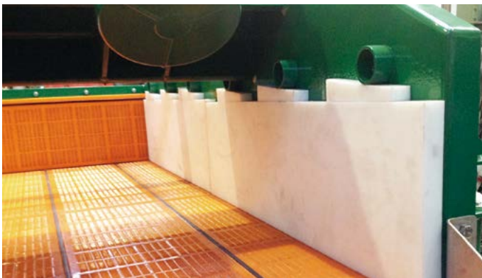
Detalle lateral de placas de polietileno
