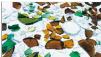
En el tratamiento de residuos de vidrio, el secado de los fragmentos de vidrio constituye un paso indispensable del proceso. DRYON garantiza un rendimiento ininterrumpido al evitar las acumulaciones de material en los puntos de transferencia, lo que facilita la separación del vidrio troceado para el proceso de clasificación. Además, extrae las materias orgánicas no deseadas, aspirándolas durante el secado.
