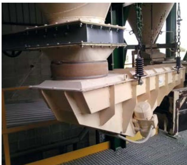
Transportador vibrante electromecánico
