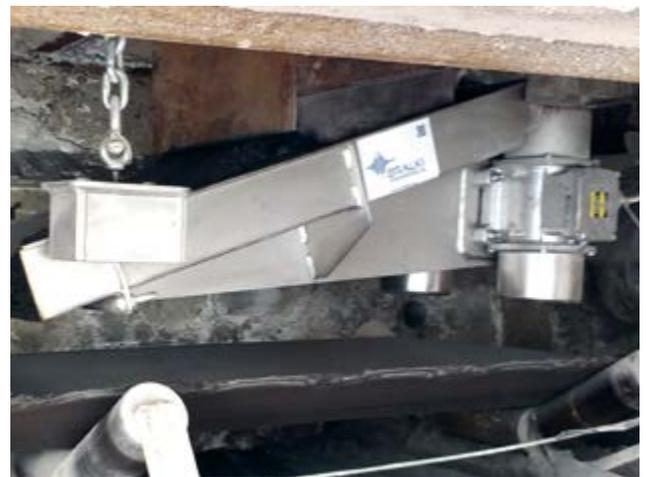
Según requerimientos se puede suministrar el equipo con el alimentador vibrante integrado en un pico de tolva, incluso con un cierre de barras superior, para su colocación directa sobre la boca de salida de la tolva.
