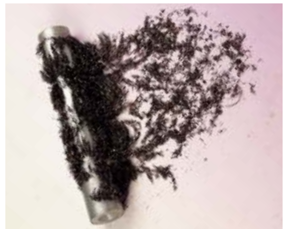
Esempio di attrazione candelotto al Neodimio Esempio de atracción barra magnética de Neodimio Exemple d'attraction de bougie au Néodyme Example of Neodymium candle attraction Anzeihungsbeispiel Neodymstangen
