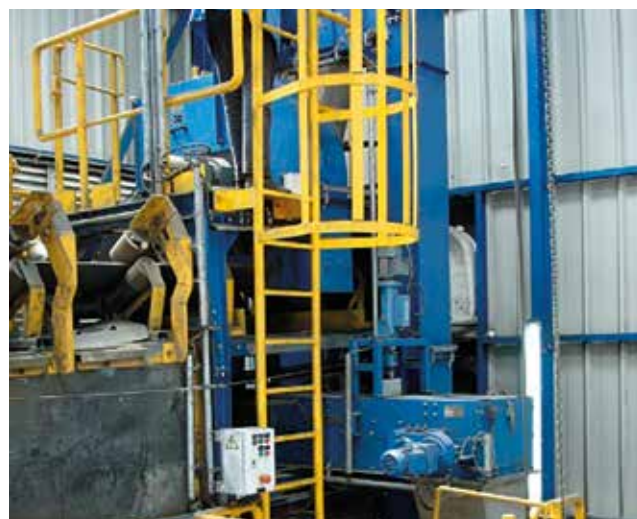
Instalación para la toma de muestra de concentrado de cobre
