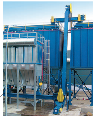
Transportador de cadena para llenado de silos
