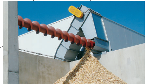
Tornillo sinfín para llenado de bunker. Screw conveyor for bunker filling.
