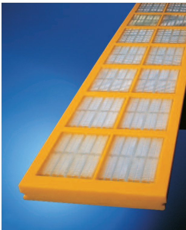
SG-H = Fundido con segmentos. Elemento modular para aplicaciones de escurrido conformado por material fundido con segmentos termoplásticos de PU inyectado para altura de capa de hasta 250 mm
