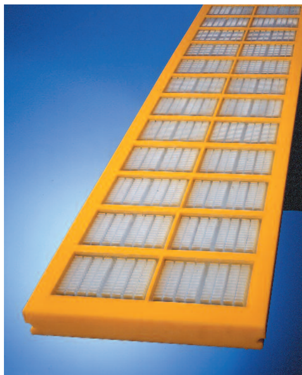
SG-HH = Fundido con segmentos. Elemento modular para aplicaciones de escurrido conformado por material fundido con segmentos termoplásticos de PU inyectado para altura de capa de hasta 300 mm
