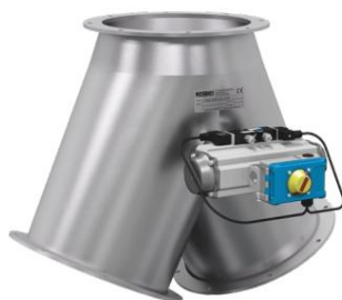
Ejemplo: Válvula de dos vías con collar de entrada de 50°, simétrica, construcción DN >300 mm con bridas soldadas, accionada neumáticamente con un actuador rotatorio
