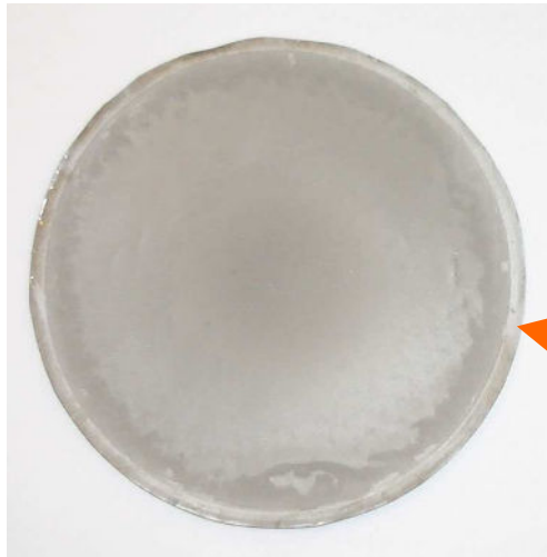
Filtros de acero inox D=150 mm m ~300 mg/filtro
