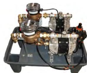
Cofre de bombas de carga y descarga
