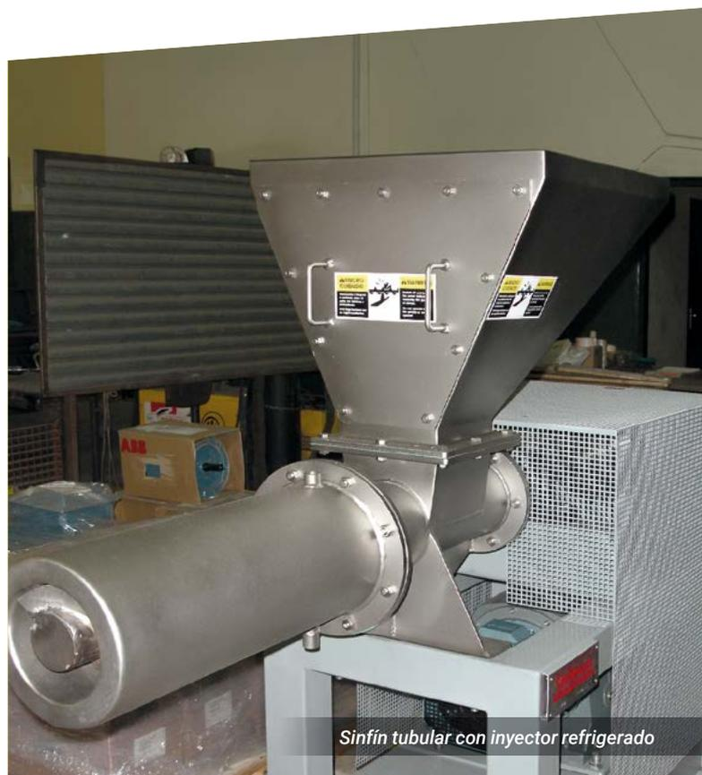
Sinfín tubular con inyector refrigerado
