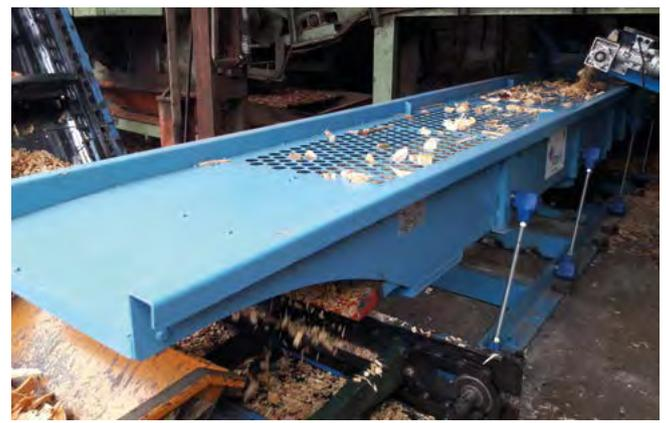
**TRANSPORTADOR VIBRADOR NEUMÁTICO**
