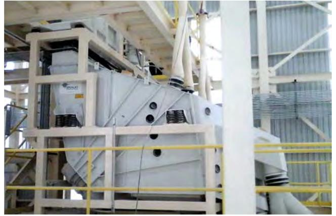
**CRIBAS CON ACCIONAMIENTO MECÁNICO**
