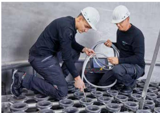
Medición con sonda en la cámara de aire limpio: medición, análisis y evaluación del comportamiento del flujo en condiciones de funcionamiento.
