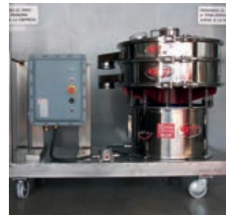
Ejemplo Tamizadora FTI-0800ATEX Zona 22 3D T4 con malla de #125µ, montado con cuadro de maniobra eléctrico sobre superficie móvil según especificaciones de cliente.
