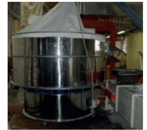
Aplicación de tamizado para separación de partículas en suspensión en forma de polvo (#150µ). Tamizadora adaptada para línea de lecho fluidizado
