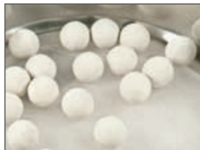
Bolas alimentarias para desobturar la malla de los tamices.
