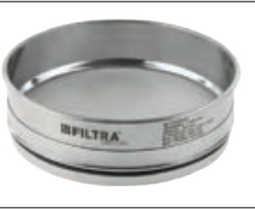
Tamiz con bastidor y malla de acero inoxidable.
