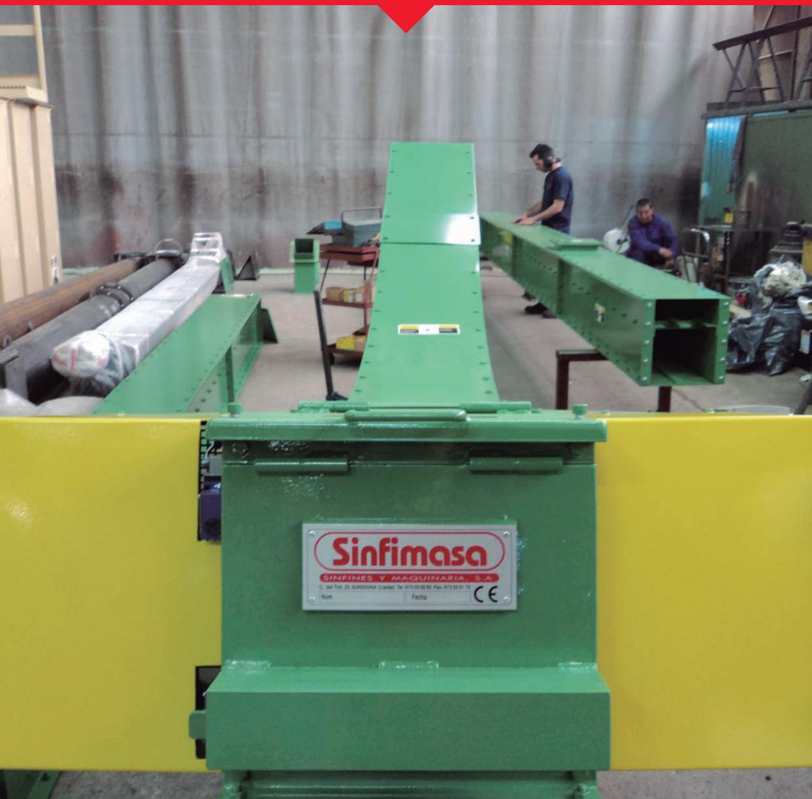
Tipo "industrial" para el transporte de: áridos, cemento, morteros, carbón, polvos muy abrasivos, ...
