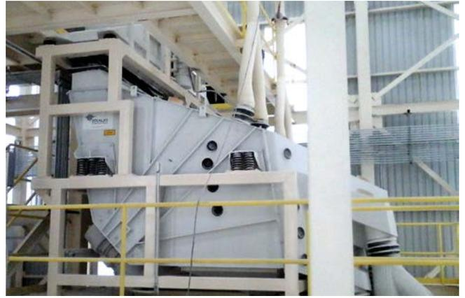
**CRIBAS CON ACCIONAMIENTO MECÁNICO**
