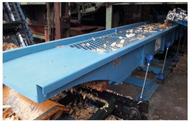
**TRANSPORTADOR VIBRADOR NEUMATICO**
