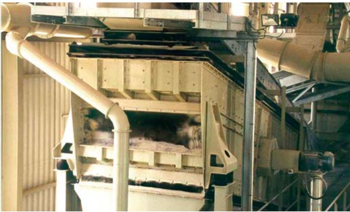
**CRIBAS FLIP-FLOW BINDER BIVITEC**
