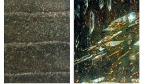
Compuesta de una base de acero dulce o inoxidable, revestida mediante soldadura en una cara con carburos de cromo cristalinos en una matriz de hierro. La deposición de la capa de carburos se realiza con máquinas automatizadas con control digital, para asegurar la correcta densidad y orientación de los cristales de carburos.
