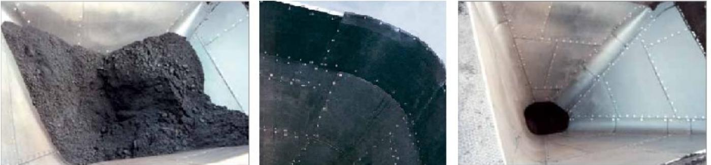
Se puede mejorar considerablemente el deslizamiento mediante medidas que reducen la fricción e impiden la adhesión con revestimientos antiadherentes de ABRARESIST y KALENBORN, que ofrecen los materiales adecuados.
