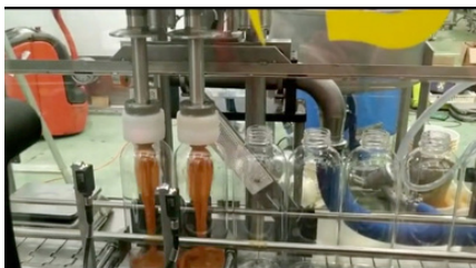
*Detalle boquillas de dosificación
